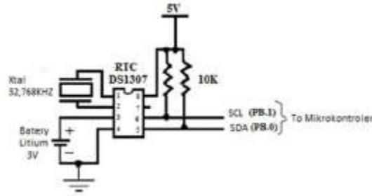
Gambar 5 Rangkaian RTC
